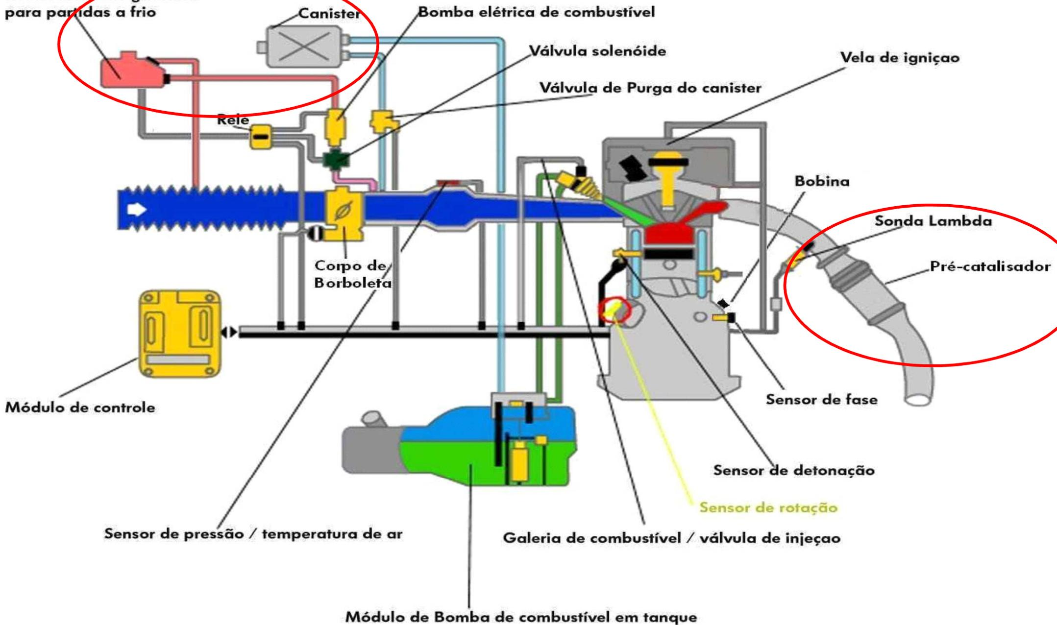
O sinal da Sonda Lambda é usado para determinar se a mistura queimada está rica (excesso de combustível) ou pobre (excesso de ar);
