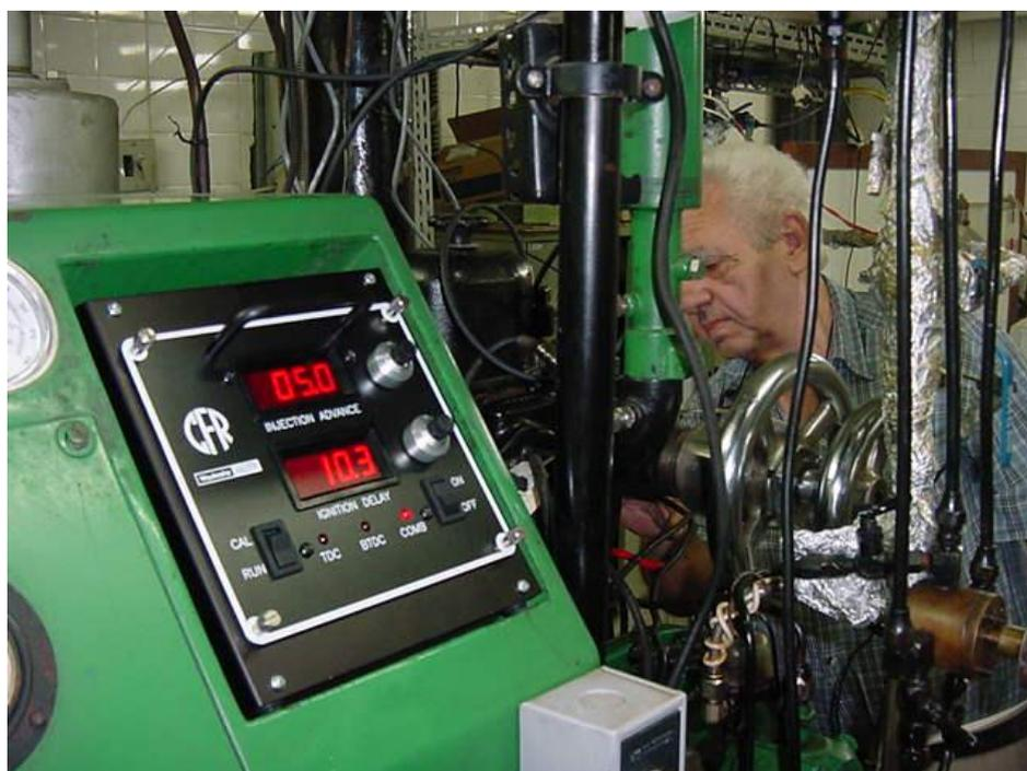
Figura 6.2 - Medidor de Avanço de Injeção e Atraso de Ignição
