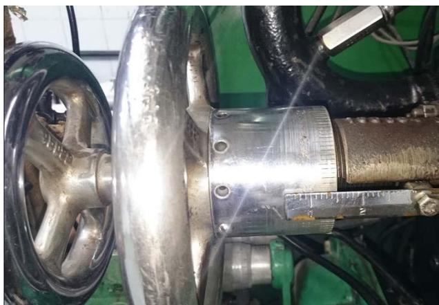
**Figura 22:** Micrômetro que mostra a posição do volante
