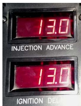
**Figura 21:** Mostrador digital do avanço da injeção e atraso de ignição
