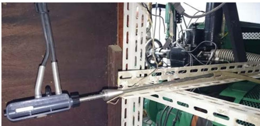
**Figura 24:** Sonda do analisador conectada ao duto de descarga do motor
