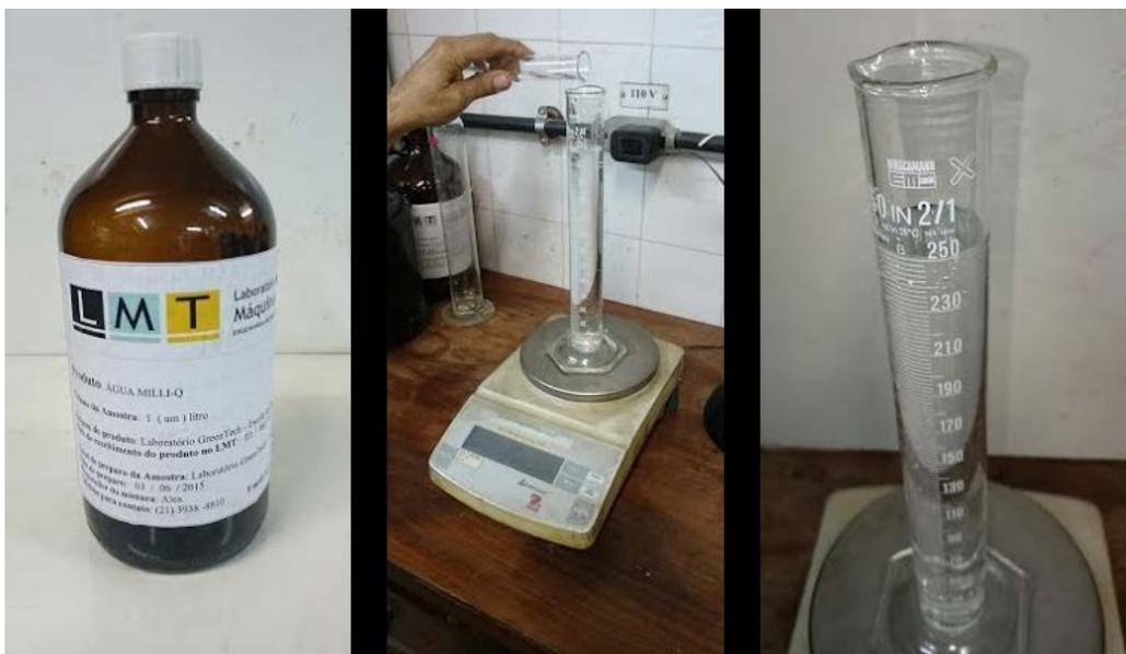
**Figura 16:** Adição de água Milli-Q até a marca de 250mL
