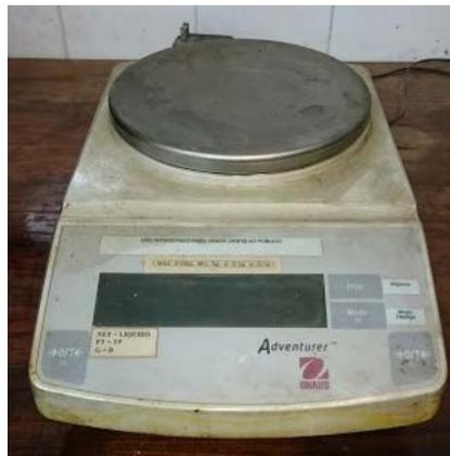
**Figura 9:** Balança analítica utilizada no experimento
