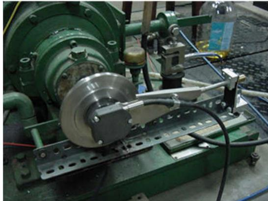
Figura III.4 – *Encoder* óptico instalado no motor AGRALE (SOUZA JUNIOR, 2009).
