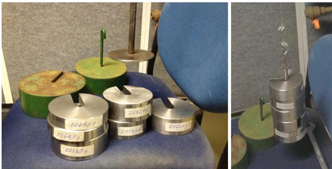
Figura 6.4 - Massas calibradas.
