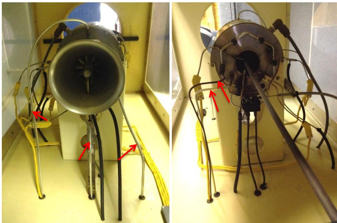
Figura 7.4 - Vista frontal e traseira da turbina SR-30 com indicações das tubulações rígidas.
