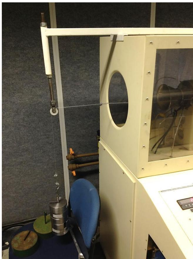
**Figura 6.5 - Sistema de calibração durante medição.**
