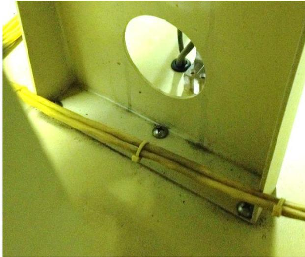
Figura 7.6 - Disposição dos parafusos de fixação da turbina na bancada.
