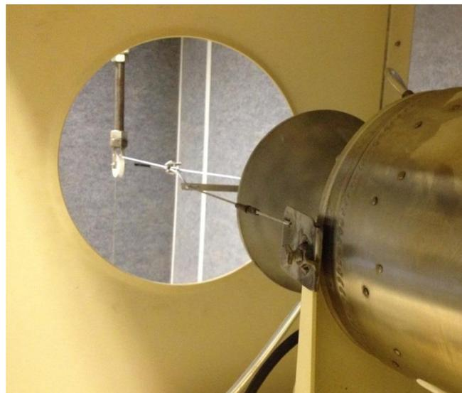
**Figura 6.3 - Fixação dos cabos de tração na turbina por ganchos.**
