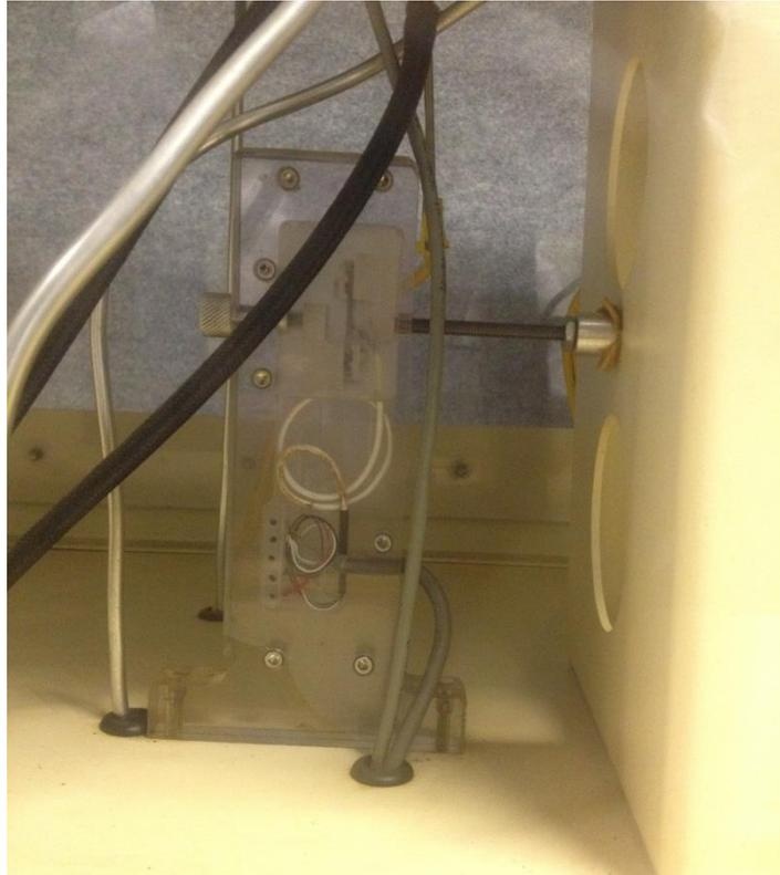
**Figura 6.14 - Célula de carga da bancada e sua estrutura de fixação.**
