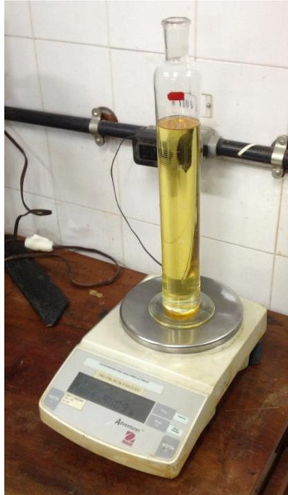
Figura 4.7 – Procedimento para determinação das massas específicas
