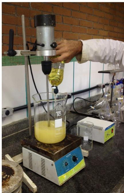
Figura 4.3 – Adição de óleo de soja para iniciar reação de transesterificação
