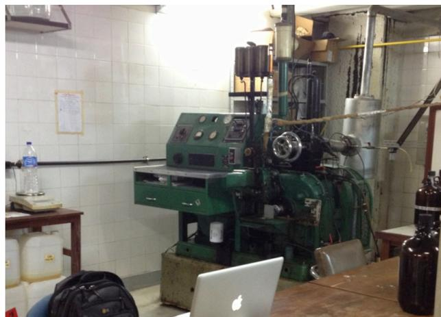
Figura 3.1 – Motor CFR Cetano e ambiente de trabalho
