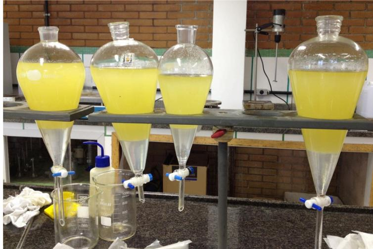
Figura 4.5 – Procedimento de lavagem. Éster retransesterificado na fase superior, água com impurezas abaixo.
