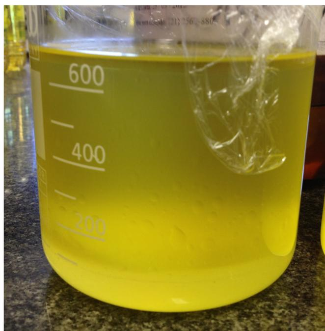
Figura 4.8 – B5E15 em observação no IVIG, após alguns dias. Notar as bolhas presentes na lateral do béquer, o aspecto ainda turvo e a separação de fases na camada superior.
