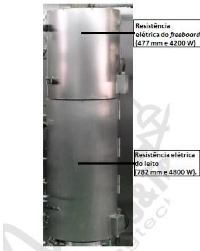
Figura 7.4 – Sistema de aquecimento externo (retirado de PINHO, 2012).
