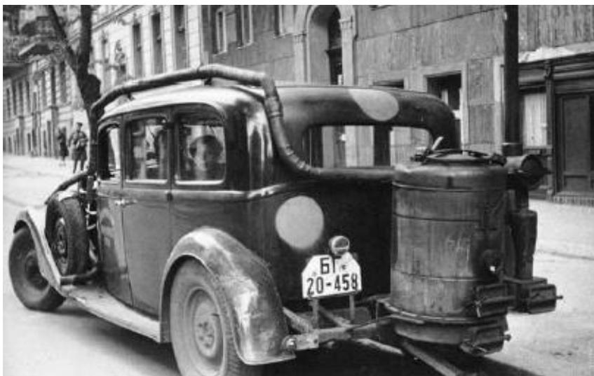
Figura 3.1 - Carro com um gerador de gás de madeira durante a Segunda Guerra Mundial (retirado de SIEDLECKI, 2011).
