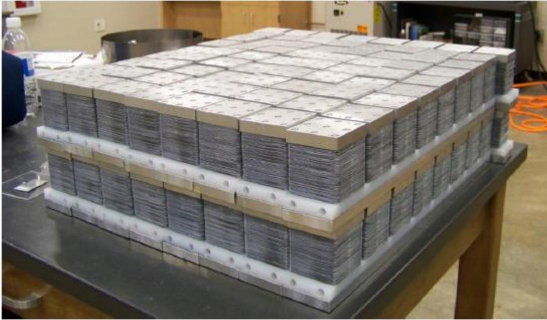
**Figura 2: Reator de biodiesel a partir de microrreatores ( *Billo et al. , 2014* )**
