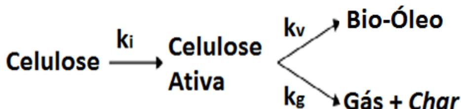
Figura 3.1 – Mecanismo de Brodo-Shafizadeh. Adaptado de VAN DE WEERDHOF (2010).
