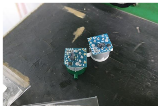
Figura 27 - Sensores de SO 2 (verde) e O 2 (branco).
