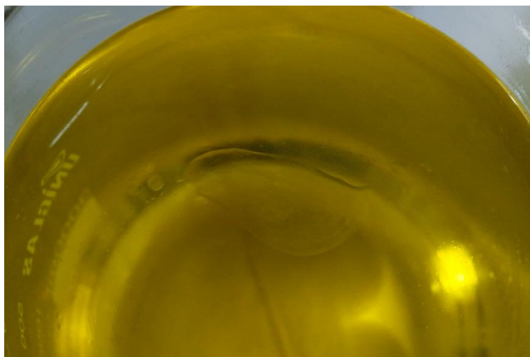
Figura 35 - Separação de fases na amostra B10E15. Etanol se precipita na superfície.
