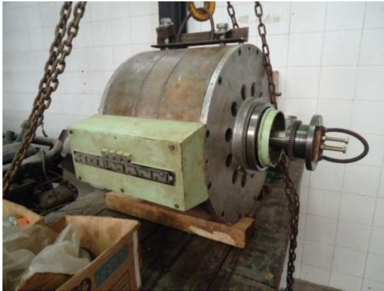
Figura 3.8. Núcleo do dinamômetro montado.
