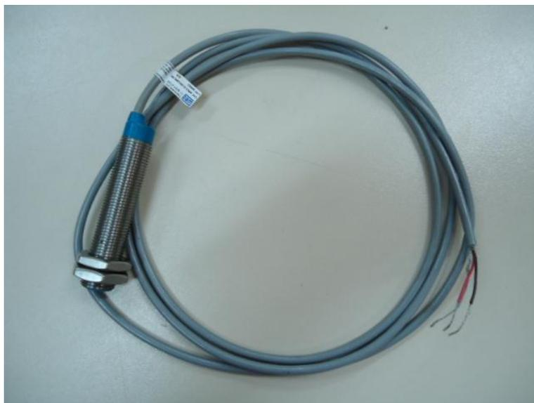
Figura 4.5. Sensor Pick-Up Magnético DLG SP02-5 8G1SM/80
