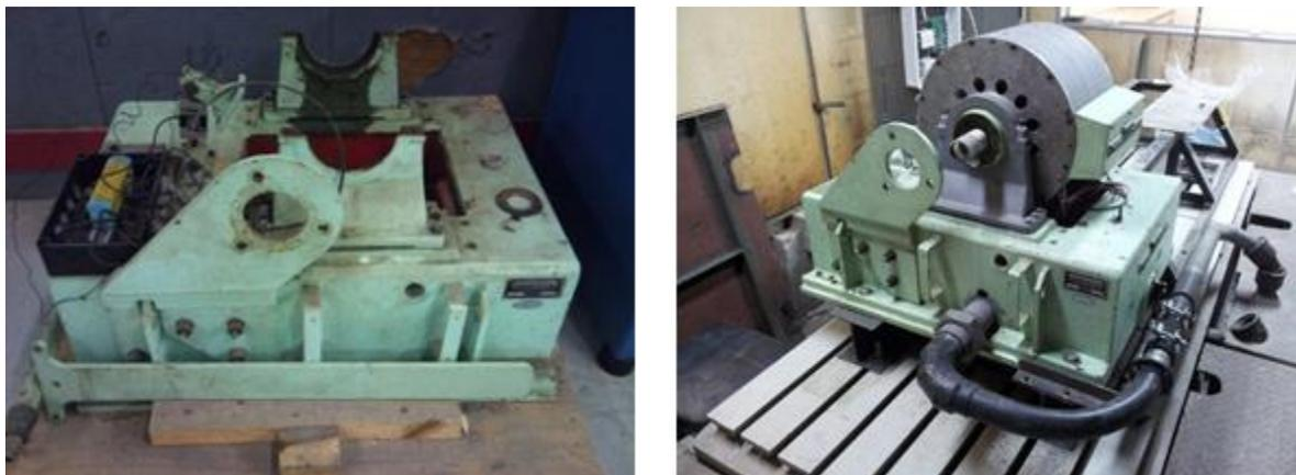
Figura 6.1. Dinamômetro antes e depois da recuperação.
