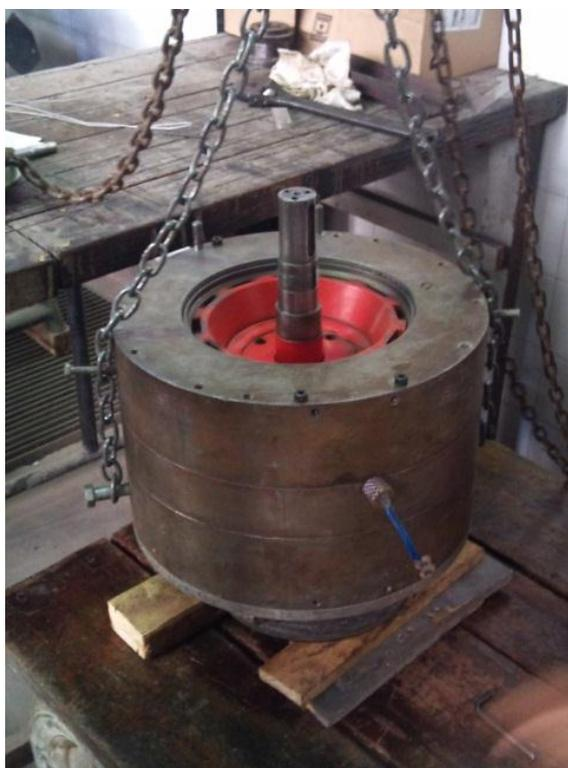
Figura 3.7. Núcleo do dinamômetro com rotor exposto.
