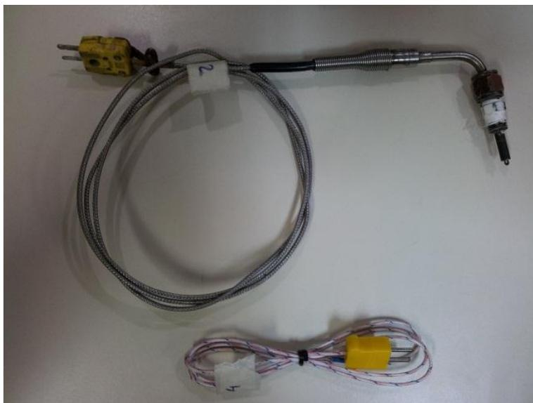
Figura 4.7. Termopares de haste e de multímetro utilizados no banco de provas
