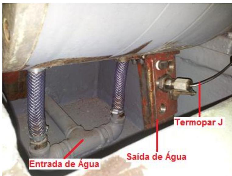
Figura 5.4. Detalhe da entrada e saída de água de refrigeração no núcleo.
