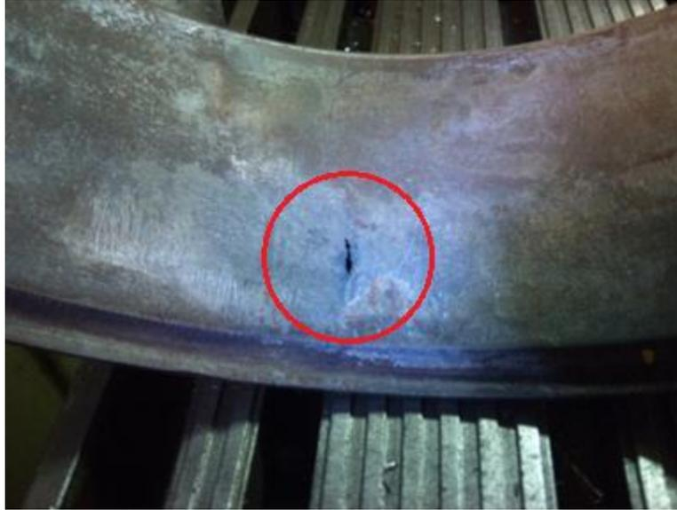
Figura 3.2. Furo na bucha causado por corrosão
