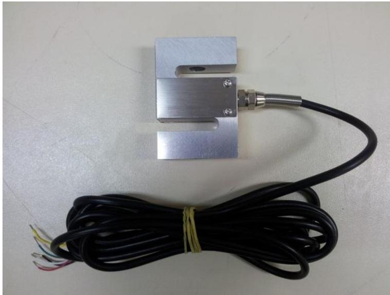
Figura 4.3. Célula de Carga MK CSA/ZL-100
