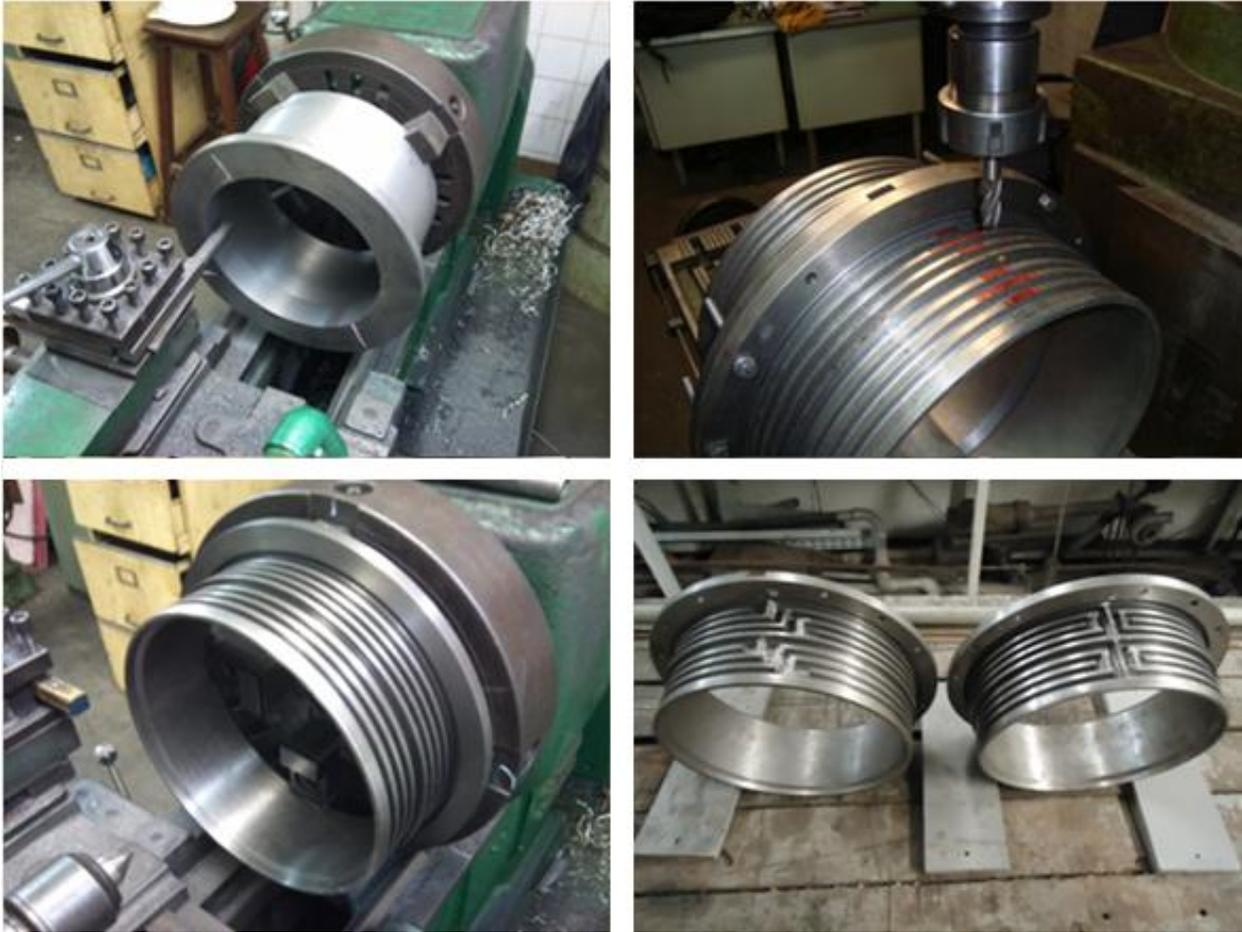
Figura 3.3. Usinagem e acabamento das Buchas de Refrigeração.
