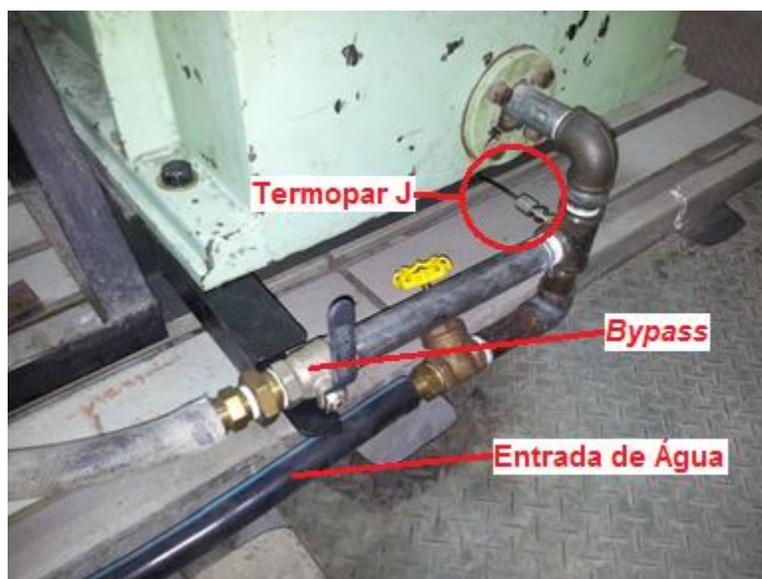
Figura 5.3. Entrada da água de refrigeração
