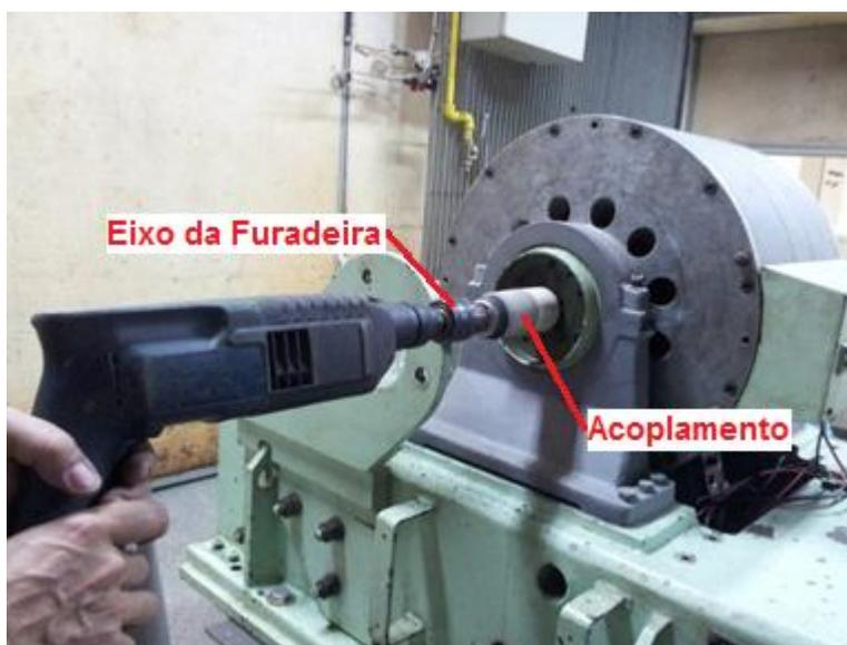
Figura 5.13. Novo experimento para validação da curva de calibração do sensor de rotação.
