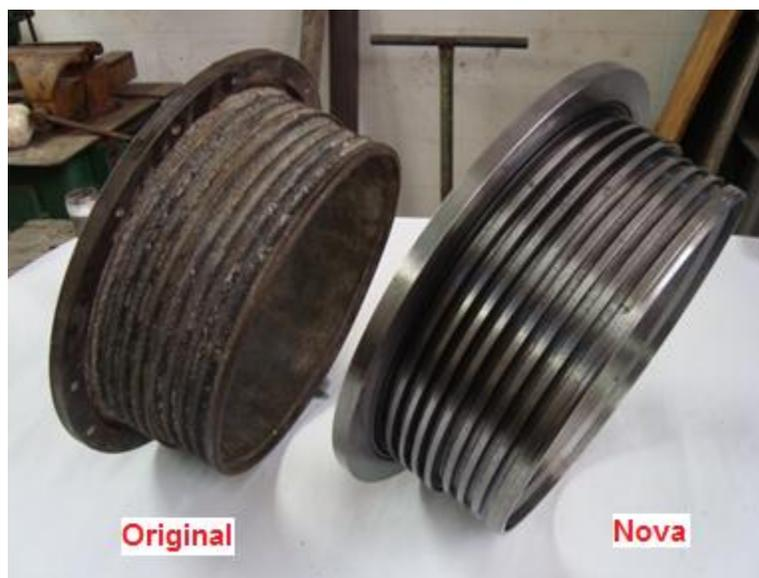
Figura 5.1. Comparação entre as buchas de refrigeração original e nova.
