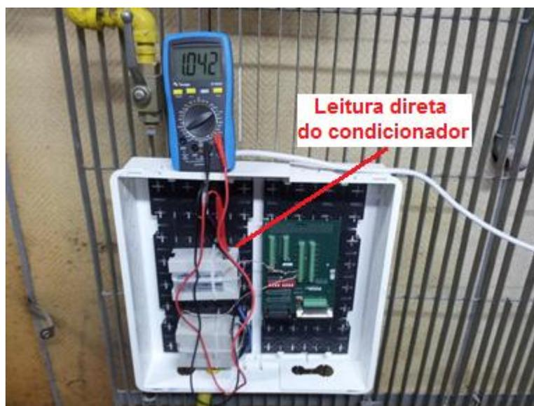
Figura 5.14. Leitura da tensão realizada diretamente no condicionador de sinais
